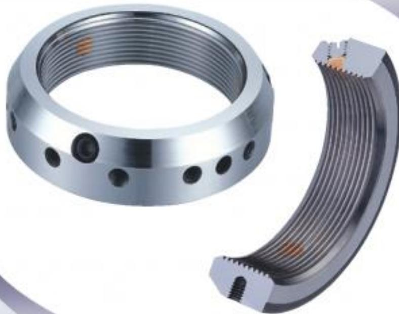
此型螺帽較SBL-A螺帽不同在於螺帽本身外圓增加了可調整的平衡螺絲孔，當主軸設計無法使用SBL-B型時，此型螺帽是最佳的代替品。本設計再配合公司所開發的消音螺絲，將其平衡螺絲孔塞住可完全降低高速所帶來的噪音問題。
